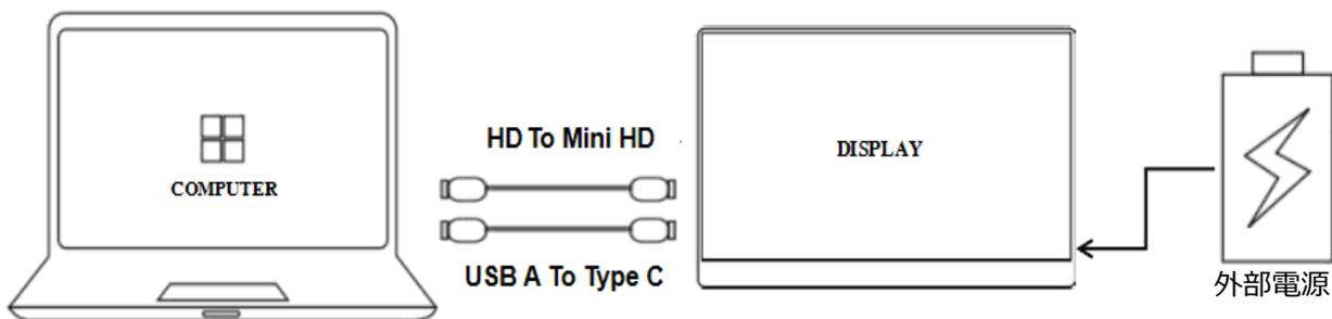
本製品は miniHDMI ポートを搭載しています。本機側 miniHDMI とコンピューター側 HDMI ポートを接続してください。また付属の電源アダプターまたは電源供給用に Type-C ケーブルで接続します。USB ポートのないコンピューターの場合は付属のアダプターまたは 5V/3A 以上の外部電源に接続する必要があります。
