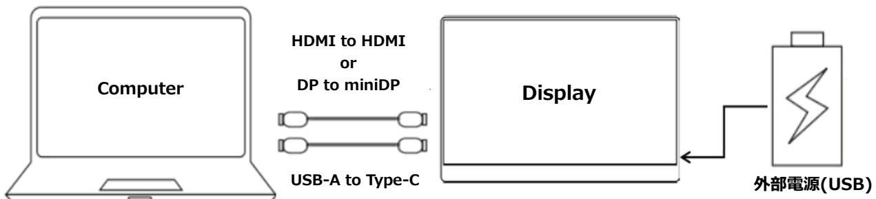
本製品は HDMI ポートと miniDP ポートを搭載しています。本機側 HDMI とコンピューター側 HDMI ポート、または本機側 miniDP とコンピューター側 DP ポートを接続してください。また電源供給用に電源アダプターまたは USB-A to Type-C ケーブルを接続します。
