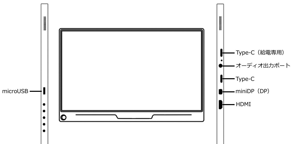
**Type-C (給電専用)** : 給電専用のポートとなります。
