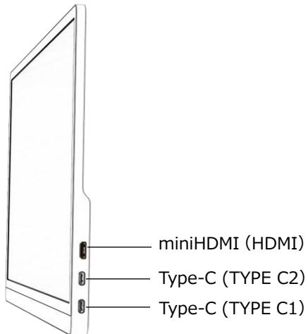
**Type-C ポート x 2:** Type-C 交換デバイス専用です。
