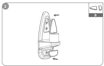
プラスチックカバー2個を壁プレートにはめ込みます。
