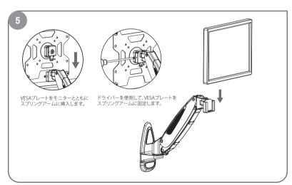
モニターを持ち上げプレート部分をアームのヘッドスロットに挿し込みます。
