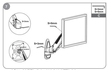
六角レンチを使用し、スイーベルとチルトを調整します。 反時計回りに回すと緩くなり、時計回りに回すと固くなります。
