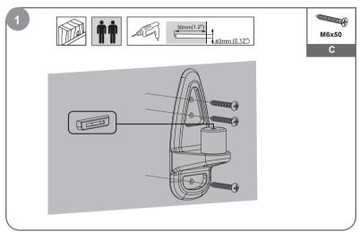
鉛筆を使って取り付け場所をマークします。壁の構造が、本製品とモニターの重量を 支えられることを確認してください。取り付け穴は間柱などのある位置に開けて下さい。
