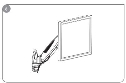
アームを十分に動かせるようにアーム関節部分に十分なたるみを残し ケーブルをケーブルカバーに挿入します。
