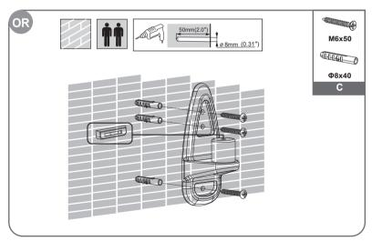
鉛筆を使って取り付け場所をマークします。壁の構造が、本製品とモニターの重量を 支えられることを確認してください。電気配線等を避けて取付けて下さい。
