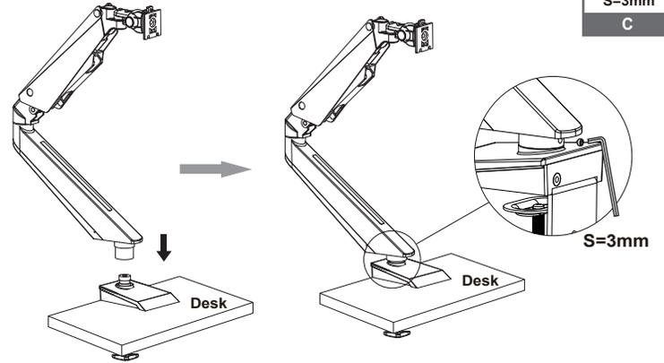
アームをベース部品に取り付け、背面のネジを締めます。
