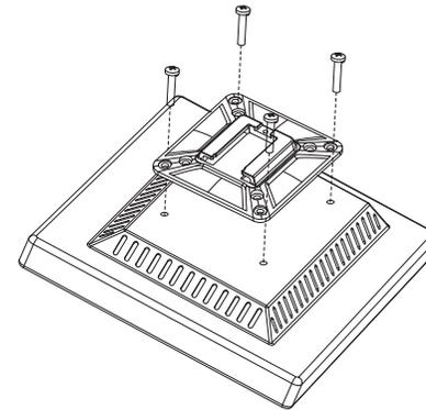
4本のネジでプレートをモニター取付けます。
