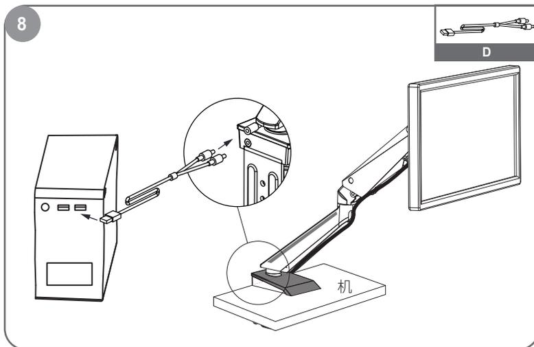
LEDバックライトを利用する時はUSBケーブルを使用してください。
