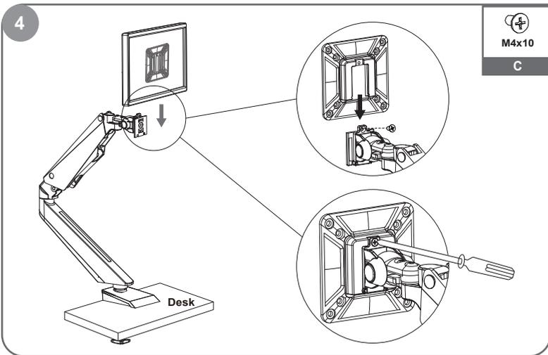
プレート部分をアームに挿し込んでモニターを取付けます。
