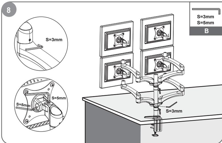
六角レンチを使用してチルトを調整します。
