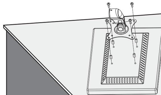
凹面への取り付け: プレートとモニターの間には4つのスペーサーを置きネジで取り付けます。
