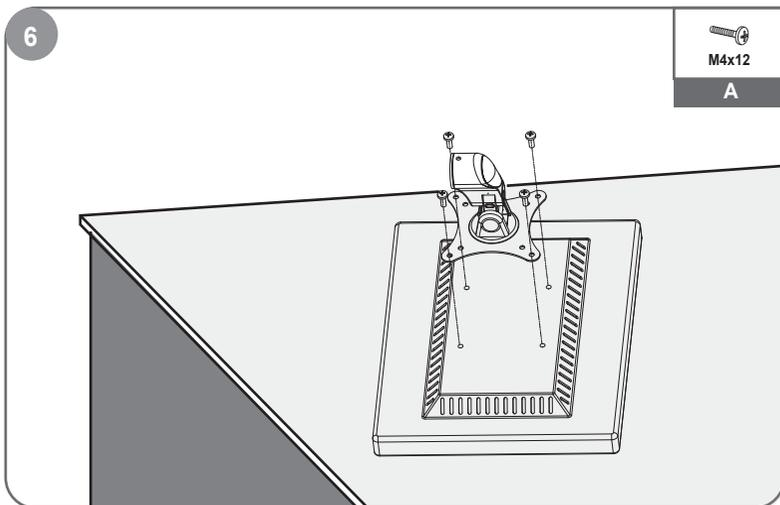
平面への取付け:4本のネジでプレートを取付けます。
