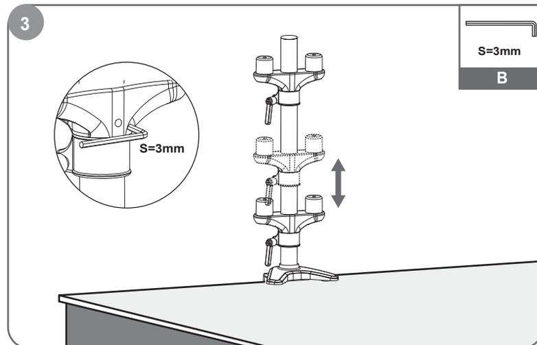
位置決めリングを適切な高さに調整し、ネジを締めてパーツを固定します。
