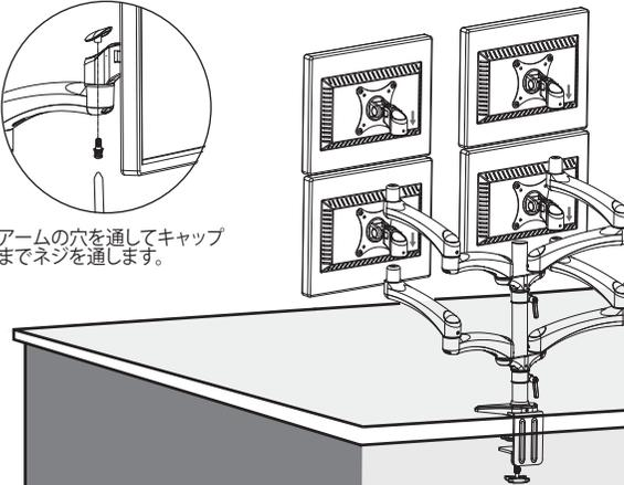
モニターを持ち上げ、プレート接続部分をアームに取付けます。
