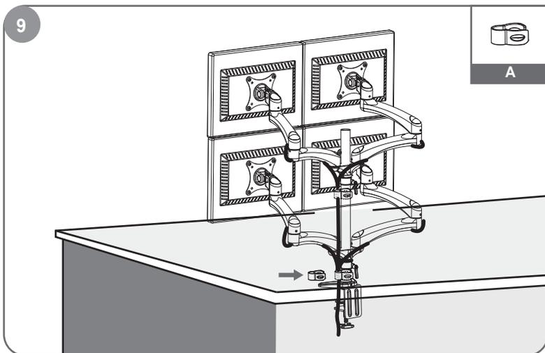
ケーブルをケーブルカバーに挿入します。アームが十分調整できるようにアームの接合部はケーブルを十分にたるみを持たせて下さい。
