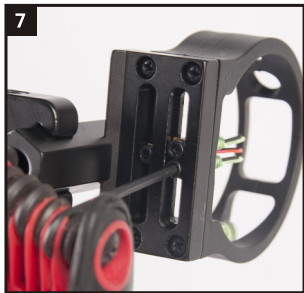
如图7所示, 螺丝拧松后可调节对应瞄点的上下位置。
