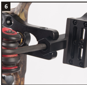
如图6所示, 螺丝拧松后可调节瞄准镜的上下位置。
