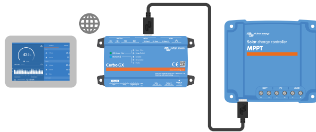
Verbindung der VictronConnect App über LAN oder das Internet (VRM Portal) mit einem GX-Gerät (z. B. einem Cerbo GX)
