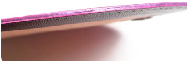
UNEBENE KANTE MEHR BASE COAT EMPFOHLEN
