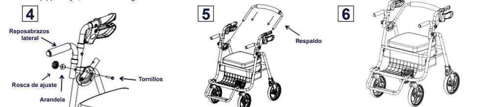
3. Finalmente, coloque el tubo del respaldo (B) en la estructura principal (A), presione el botón hasta que escuche un "clic", como en la imagen 5.
