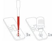
**Evitar colocar bolhas de ar na área da amostra (S) e não adicionar nenhum líquido na área de resultados.**
