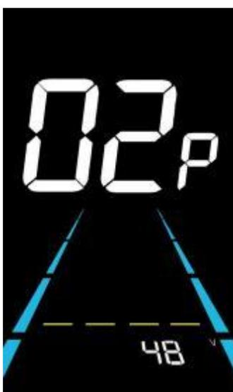
Abbildung 6-2 Schnittstelle zur Einstellung der Nennspannung
