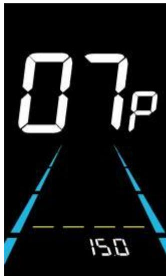
Abbildung 6-8 Schnittstelle zur Einstellung der Stromgrenze des Reglers
