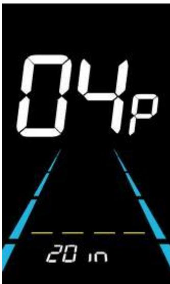
Abbildung 6-5 Schnittstelle zur Einstellung des Raddurchmessers
