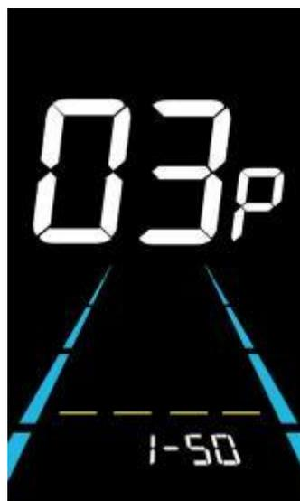
Abbildung 6-4 Schnittstelle zur Einstellung des PAS-Pegelverhältnisses
