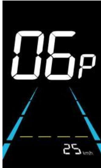
Abbildung 6-7 Schnittstelle zur Einstellung der Geschwindigkeitsbegrenzung
