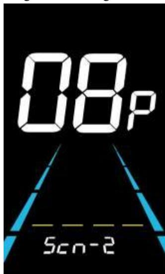
Abbildung 6-10 Schnittstelle zur Einstellung der Empfindlichkeit des PAS-Sensors
