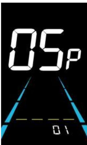
Abbildung 6-6 Schnittstelle zur Einstellung der Anzahl der Geschwindigkeitssensormagnete
