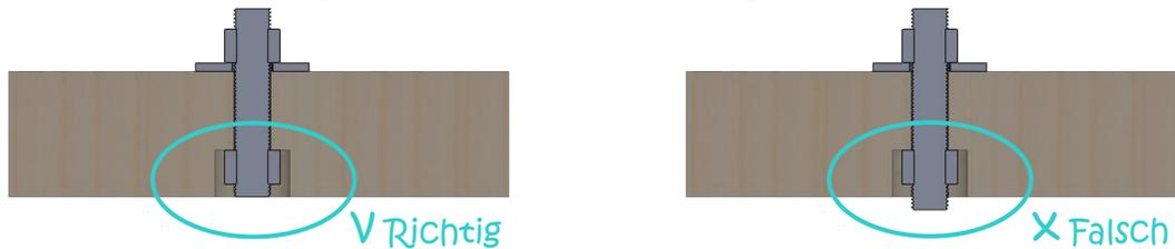
Schritt 4: Die beiden Gewindestangen handfest mit der Muffe verbinden
