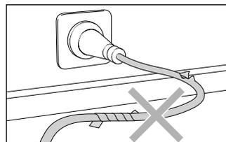
**⚠️ GEFAHR** Netzanschlusskabel nur in einwandfreiem Zustand verwenden! Netzanschlusskabel nicht beschädigen (zerren, quetschen, überfahren, ...) oder unsachgemäß reparieren. Netzanschlusskabel nicht knicken und nicht über scharfe Kanten ziehen.
