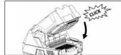
5. Schließen Sie den Filterdeckel: Den Deckel am Filterdeckelgriff (D) oder am Handgriff (A) mit einer Hand anheben. Heben Sie die Stange (C) vorsichtig mit einer anderen Hand über den Rückhaltehaken (B) und senken Sie den Deckel langsam ab. Wenn die Stange (C) über dem Rückhaltehaken (B) liegt, nehmen Sie die Hand von der Stange (C) und schließen Sie den Filterdeckel.
