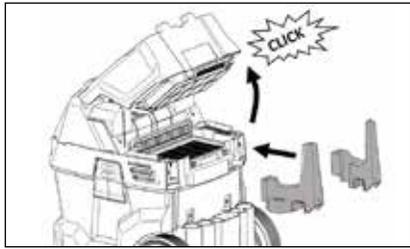
2. **Prüfen Sie, ob die Rückhaltevorrichtung richtig eingerastet ist.** Danach können Sie mit der Montage des Schlauch-/Netzanschlusskabel-Halters beginnen. Stecken Sie die Halter in die dafür vorgesehenen Aussparungen am Kopf.
