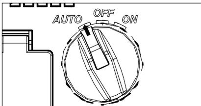
Stellen Sie den Drehknopf auf die Position Einschaltautomatik (AUTO). Der Sauger läuft nun an, sobald das Elektrowerkzeug eingeschaltet wird. Wird das Elektrowerkzeug ausgeschaltet, stoppt auch der Sauger mit einer Verzögerung. In der Verzögerungszeit wird der Saugschlauch geleert.
