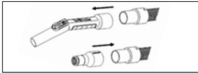
Entfernen Sie das Handrohr und befestigen Sie den Adapter für das Elektrowerkzeug am Saugschlauch.
