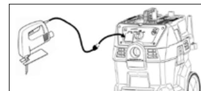
Stecken Sie das Netzanschlusskabel des Elektrowerkzeugs in die am Sauger dafür vorgesehene Steckdose ein.
