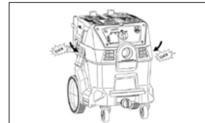
Setzen Sie den Kopf wieder auf den Behälter des Saugers. Sichern Sie den Kopf mit den Klemmen. Diese müssen wieder komplett einrasten, damit ein fester Sitz gewährleistet ist. Achten Sie beim Aufsetzen des Saugkopfes darauf, dass der Filtersack nicht zwischen Ober- und Unterteil eingeklemmt wird. Heben Sie den Sauger am Handgriff an, um sicherzustellen, dass der Deckel sicher verschlossen ist.
