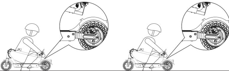
Stellen Sie sicher, dass der Roller ausgeschaltet ist. Zum Zusammenklappen den Klappmechanismus entriegeln und den Lenkervorbau biegen, um die Schnalle am hinteren Kotflügel einzuhaken. Zum Öffnen den Glockenauslöser drücken, um ihn aus der Schnalle zu entfernen, den Lenker aufrichten und die Klappstruktur verriegeln.
