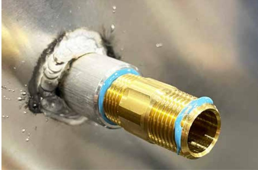
Foto 16: Fijación del niple de ½ in × 2 in al acoplamiento de la placa
