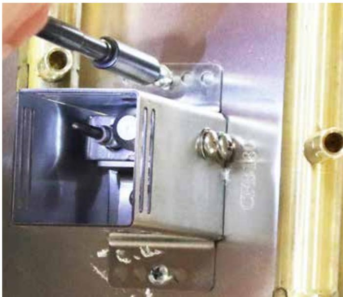
Foto 5: Fijación del piloto a la placa/bandeja
