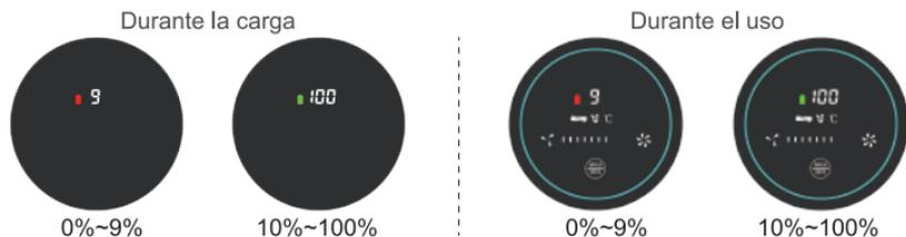
Durante la carga, las 3 luces indicadoras de la batería parpadean cíclicamente. Durante el uso, cuando la batería está al 0-33%, se enciende 1 luz, 2 luces al 33-66%, y 3 luces al 66-100%.
