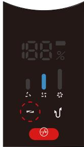
**Solución:** Retire el cepillo del suelo y limpie las materias extrañas envueltas alrededor del rodillo. Asegúrese de que el cabezal del cepillo se ha separado de la unidad principal para evitar que la máquina se ponga en marcha accidentalmente y provoque lesiones personales.
