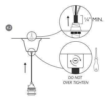
PUSH CORD UP BY AT LEAST 1/4 INCH TO REMOVE STRAIN FROM THE ELECTRICAL CONNECTION TIGHTEN THE CORD GRIP GRUB SCREW TO FIRMLY SECURE CORD IN PLACE CARE SHOULD BE TAKEN NOT TO DAMAGE THE CORD
