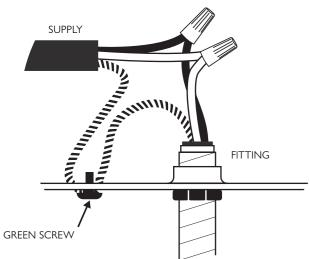
CONNECT **NEUTRAL CABLES** TOGETHER WITH WIRE NUTS CONNECT HOT CABLES TOGETHER WITH WIRE NUTS CONNECT GROUND CABLES TOGETHER USING GREEN SCREW ON FIXING STRAP
