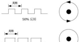
从上图中我们可以清楚的看到当PWM为75%(1.5ms)时,电机停止转动,当PWM为50%(1ms)时,电机反向转动,而当PWM为100%(2ms)时电机正向转动。当然电调不仅仅会让电机正反转,而是可以通过PWM的占空比大小来调节电机转动的速度。当PWM由75%逐渐变化到50%时,电机就会由停转不断反向加速转动,直到反向转动达到最大值。而PWM由75%逐渐变化到100%时,电机由停转不断正向加速,直到正转达到最大值。就是说PWM是一个可以连续变化的信号,有效范围是50%到100%.
