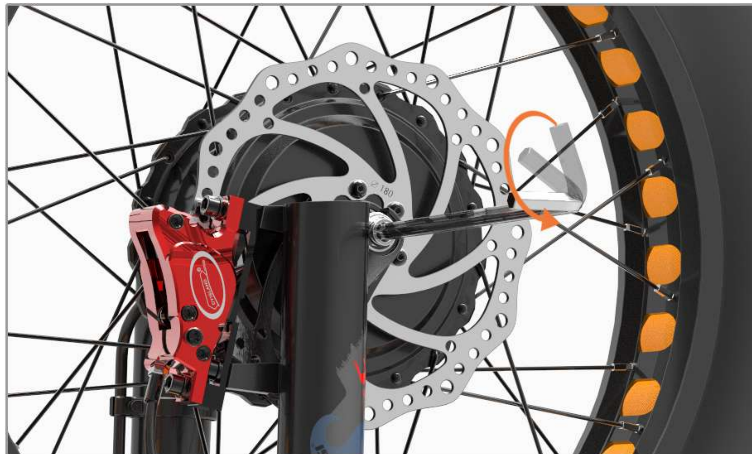
07 Serrez la vis avec l'outil
