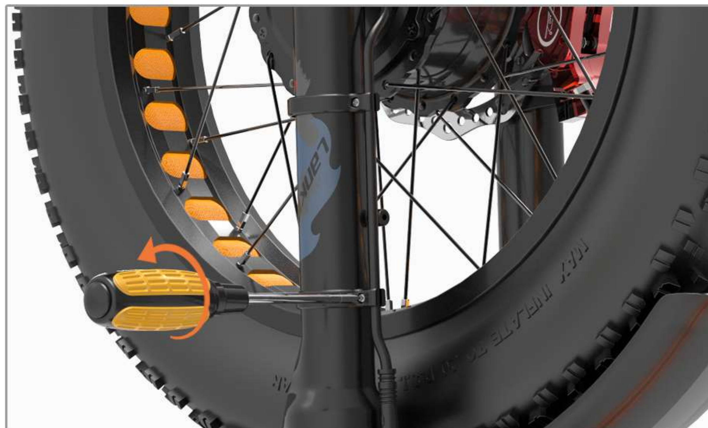
10 Tendez le câble entre les deux attaches et serrez la vis
