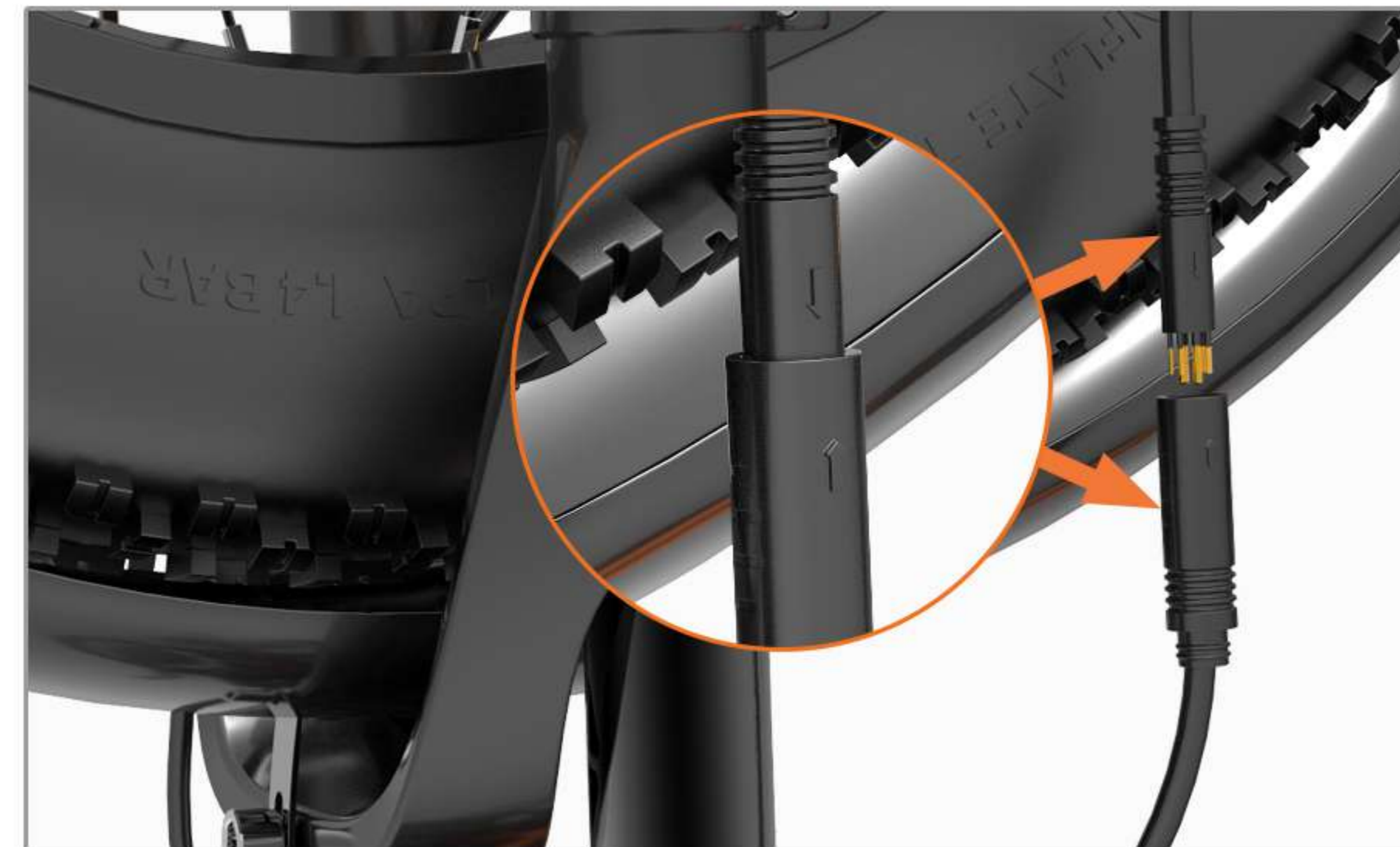
08 Connectez la fiche du câble du moteur de la roue avant *Faites attention à l'alignement des flèches entre les lignes lors de la liaison
