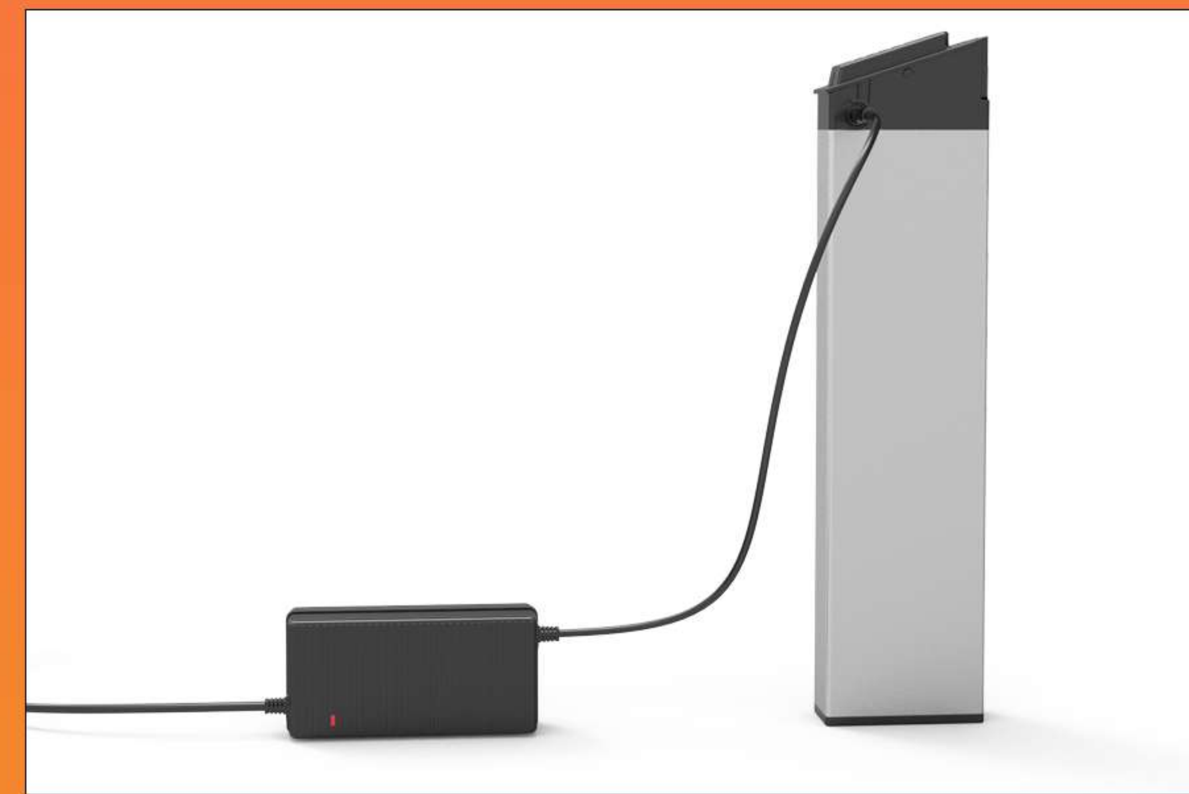
B. Enlever la batterie de l'E-BIKE et la charger séparément
