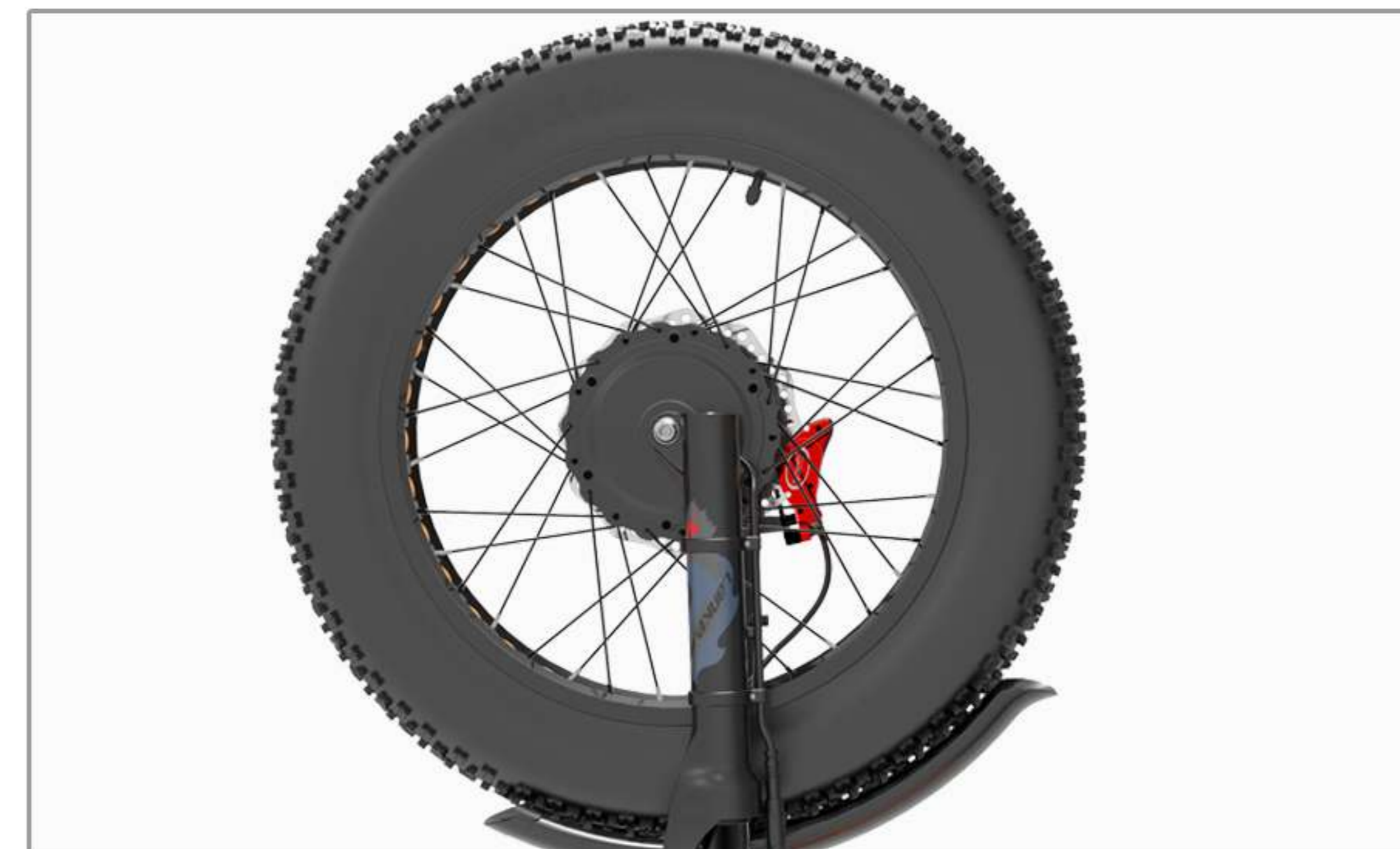
08 Connectez la fiche du câble du moteur de la roue avant *Faites attention à l'alignement des flèches entre les lignes lors de la liaison
