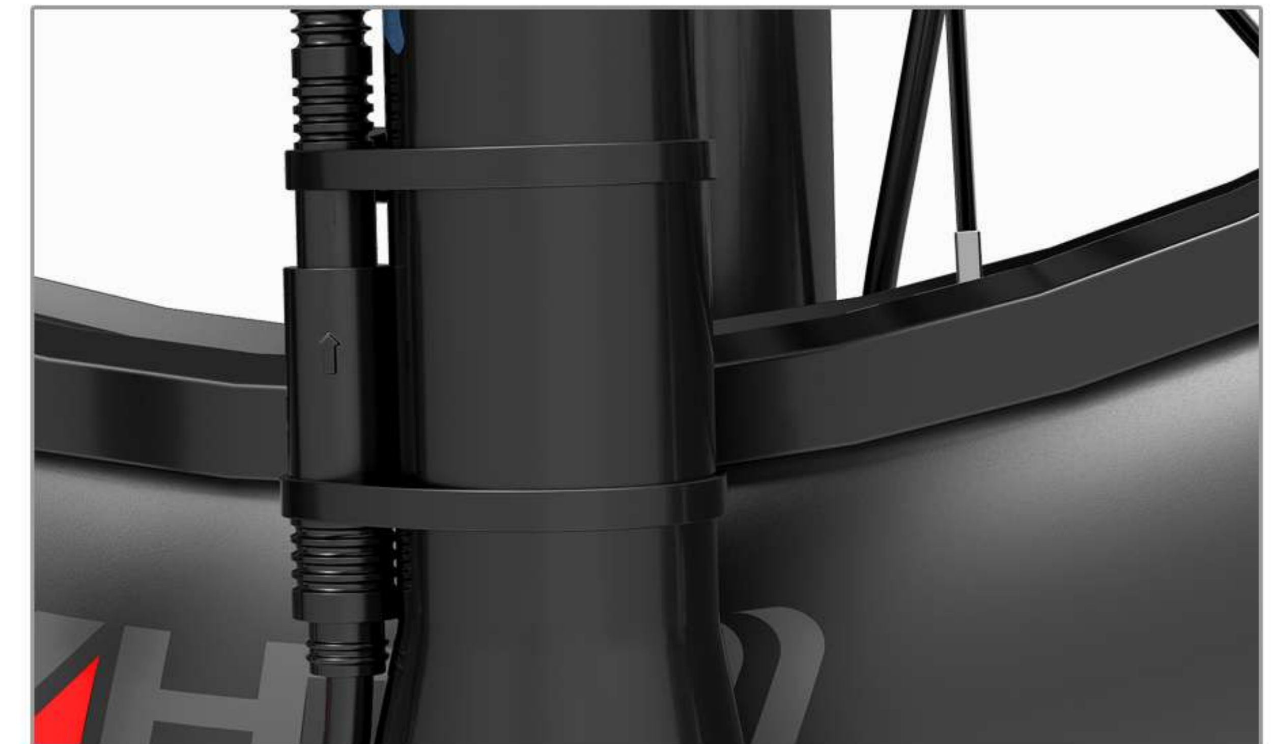
09 Une fois le fil du moteur de la roue avant connecté, utilisez les attaches pour fixer le fil sur la fourche avant.
