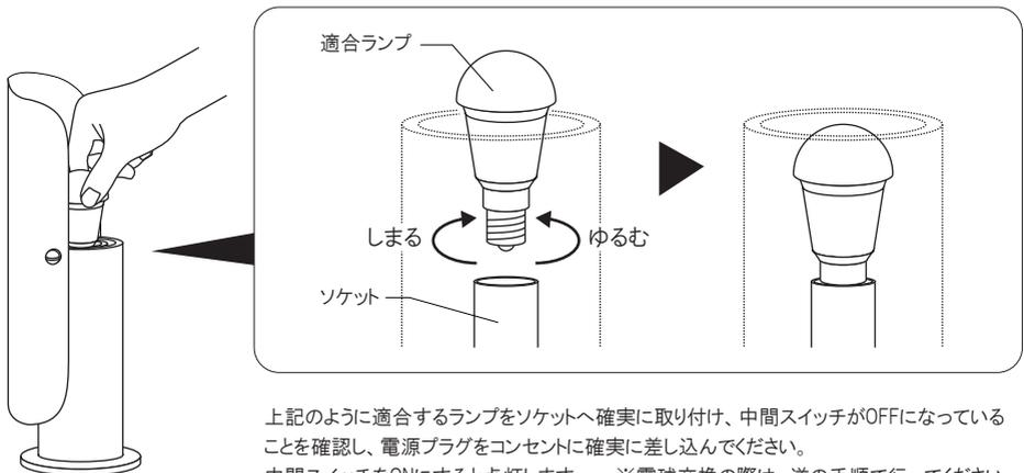
上記のように適合するランプをソケットへ確実に取り付け、中間スイッチがOFFになっていることを確認し、電源プラグをコンセントに確実に差し込んでください。
