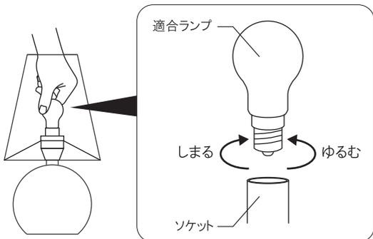
適合するランプをソケットへ確実に取り付けてください
