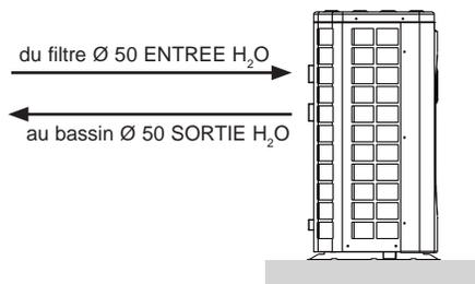
Installer une vanne dite "by-pass" entre l'entrée et la sortie de la pompe à chaleur.
