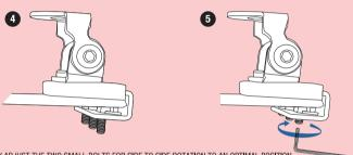
6. USING A HEX KEY ADJUST THE TWO SMALL BOLTS FOR SIDE TO SIDE ROTATION TO AN OPTIMAL POSITION
