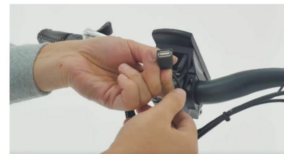
5. Bitte entfernen Sie die Gummiabdeckung und schließen Sie bei Bedarf den USB-Anschluss an.
