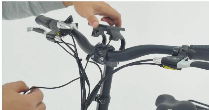
1. Bitte bringen Sie das Display in der richtigen Position am Lenker an und ziehen Sie die Schrauben fest (2-3 Nm). Position am Lenker an und ziehen Sie die Schrauben fest (2-3 Nm).
