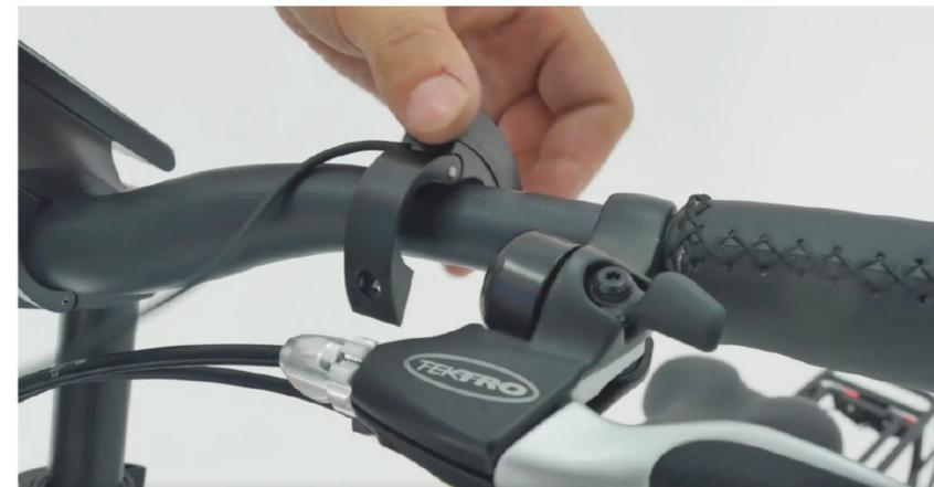
2. Bringen Sie den Anzeigeschalter in die richtige Position am Lenker und ziehen Sie die Schrauben fest (2-3 Nm).
