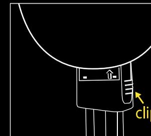
\_Collegare sempre i connettori dei tubi facendo coincidere i segni di connessione (freccia e scanalatura), altrimenti si potrebbe danneggiare il collegamento e invalidare la garanzia.
