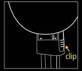
\_Collegare sempre i connettori dei tubi facendo coincidere i segni di connessione (freccia e scanalatura), altrimenti si potrebbe danneggiare il collegamento e invalidare la garanzia.
