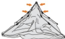
Commencez par rapprocher les arceaux de soutien supérieurs de la tente intérieure. Pressez les arceaux de support vers l'intérieur pour les rapprocher naturellement.
