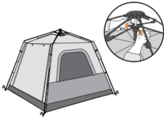
将顶端内支架向下压，使支架向外伸出，底角用地钉固定。
