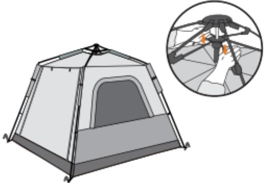
Schieben Sie die oberen inneren Zeltstangen nach unten, um sie zu verlängern, und fixieren Sie die unteren Ecken mit Heringen.
