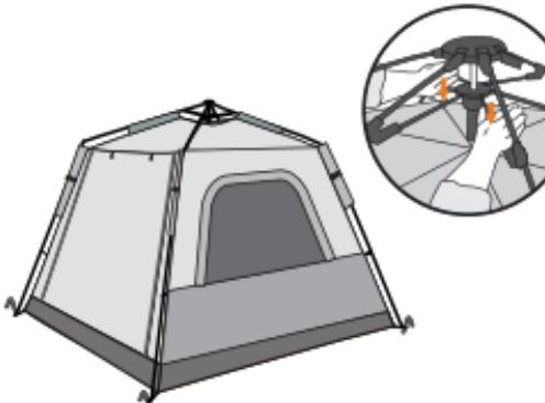
Appuyez sur les arceaux de support intérieurs supérieurs pour les étirer et fixez les coins inférieurs avec des piquets de tente.
