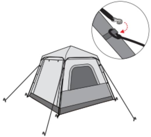
Накройте палатку внешним навесом и повесьте четыре крючка на лямки. Развяжите оттяжку и зафиксируйте ее на земле с помощью колышков.
