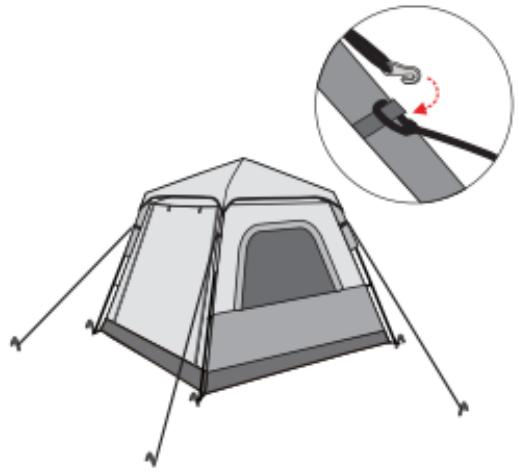
テントをトップカバーで覆い、ウェビングに4つのフックを掛けます。ウィンドロープをほどき、テントペグで地面に固定します。
