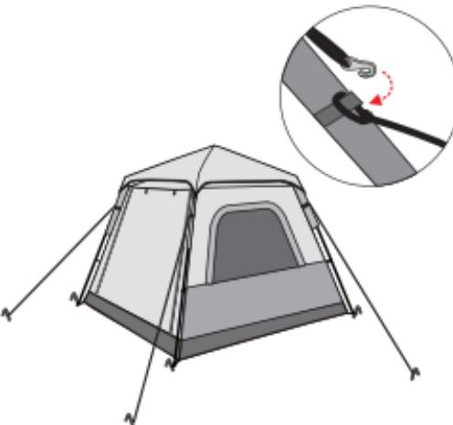
将顶披覆盖在帐篷上，4个挂钩分别勾住织带。解开防风拉绳，并用地钉固定在地上。
