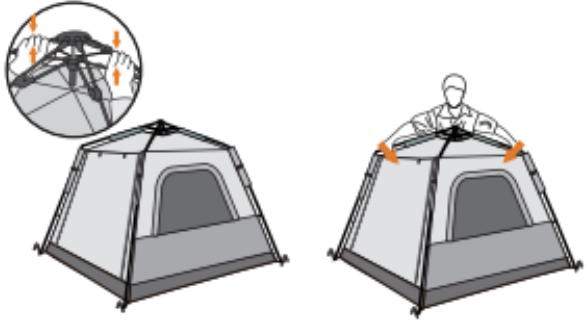
Führen Sie zuerst die oberen Zeltstangen des Innenzeltes zusammen. Drücken Sie die Zeltstangen nach innen, um sie automatisch zusammenzuführen.
