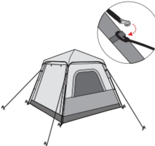
Legen Sie die obere Abdeckung über das Zelt und befestigen Sie die vier Haken an den Laschen. Lösen Sie die Abspinnleine und befestigen Sie diese mit den Heringen im Boden.
