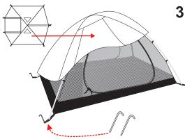
从地钉袋中取出地钉,将地钉穿过内帐底各角落的塑料环后 斜插入地面,并(如图3所示)披上外帐。
