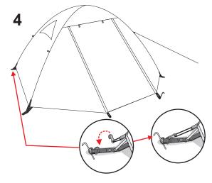
将外帐四角的塑料钩钩住内帐底的塑料环, 再将拉攀上的防护风绳固定在地面,使帐篷更加稳固。(如图4)
