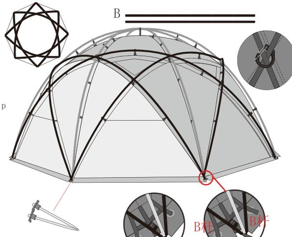
底角杆子边上的织带穿过挡泥条上的篷圈打上地钉
