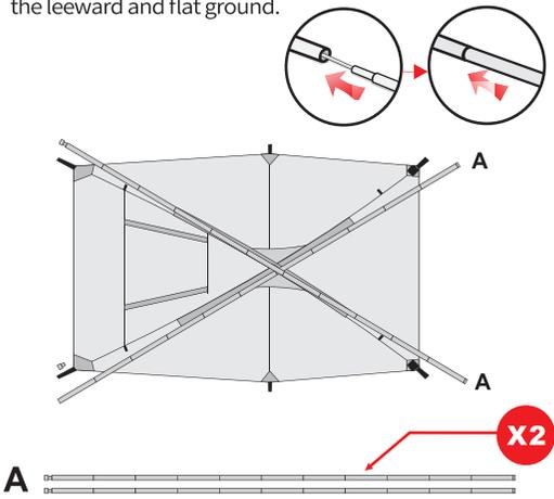
从杆子袋中取出支杆安装成图中所画的形状 (如图1) 并将支杆按图例位置摆放。
