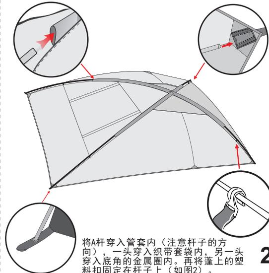
将A杆穿入管套内 (注意杆子的方向), 一头穿入织带套袋内, 另一头穿入底角的金属圈内。再将篷上的塑料扣固定在杆子上 (如图2)。
