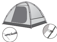
Méthode de fixation des coins inférieurs
