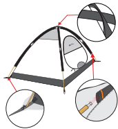
Befestigung der unteren Zeltecken
