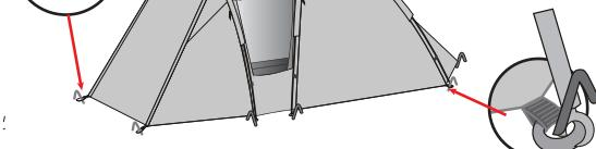
**3** 将内篷展开，找到内篷顶部的红色橄榄扣安装在圆顶篷的顶部，依次安装其它橄榄扣；底部S钩与外篷底部的金属环连接。
