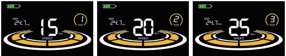
Figure 5-4 PAS level display interface
