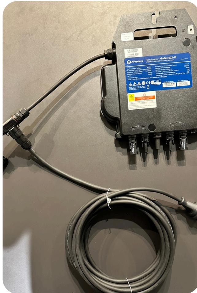
Der T-Connector verbindet nun auf der rechten und linken Seite zwei APsystems Wechselrichter, die direkt an den T-Connector verkabelt sind. Das Schukokabel wird in der Mitte in den T-Connector eingesteckt und dann auf der anderen Seite ganz normal in die Haushaltssteckdose gesteckt.
