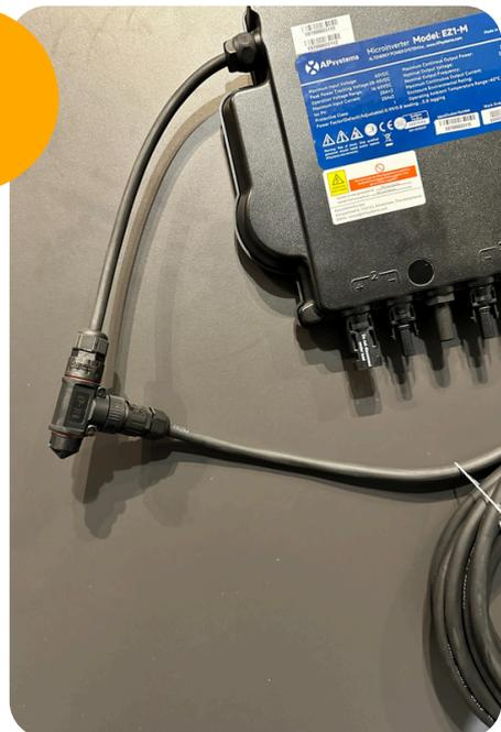
Stecke das Schukokabel in den T-Connector ein. Nun kannst du noch den zweiten Wechselrichter (identisch zum ersten) mit dem T-Connector verbinden.
