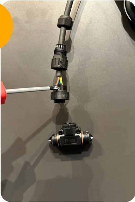
Löse den Stecker, der am APsystems Wechselrichter montiert ist. Tipp: Nutze den T-Connector, um den Stecker vom Wechselrichter leichter drehen zu können.
