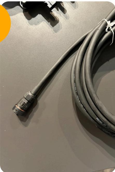
Nun wird einer der Stecker, der zu Anfangs am Wechselrichter war, an das Schukokabel geschraubt.
