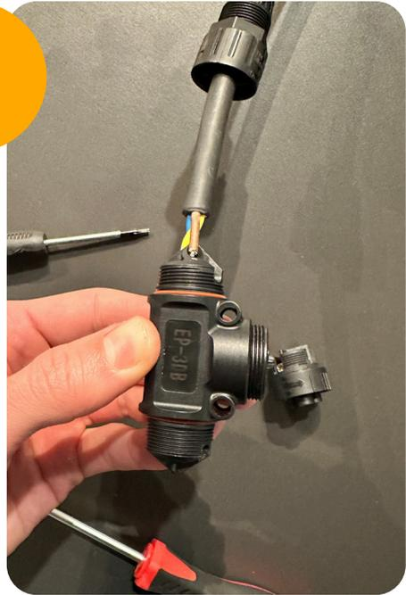
Nun verbindest du das offene Kabel der beiden Wechselrichter mit dem T-Connector. Die Kabel müssen korrekt im Stecker verschraubt werden.
