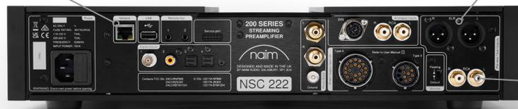
Deuxième jeu de sorties via RCA pour une connexion bi-amplification ou subwoofer
