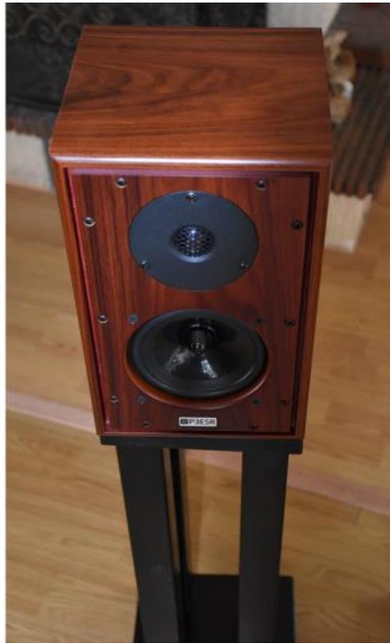
Sous sa livrée luxueuse, P3ESR XD est une enceinte à charge close à deux voies / deux haut-parleurs. Son ébénisterie en MDF de forte épaisseur est en trois parties : le coffret à quatre côtés, la face avant vissée et la face arrière également vissée.
