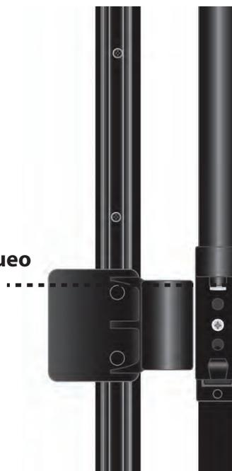
Desliza hacia abajo hasta que el **Cuerpo del Pestillo** esté alineado como se muestra y repón el **Tornillo de Bloqueo**.
