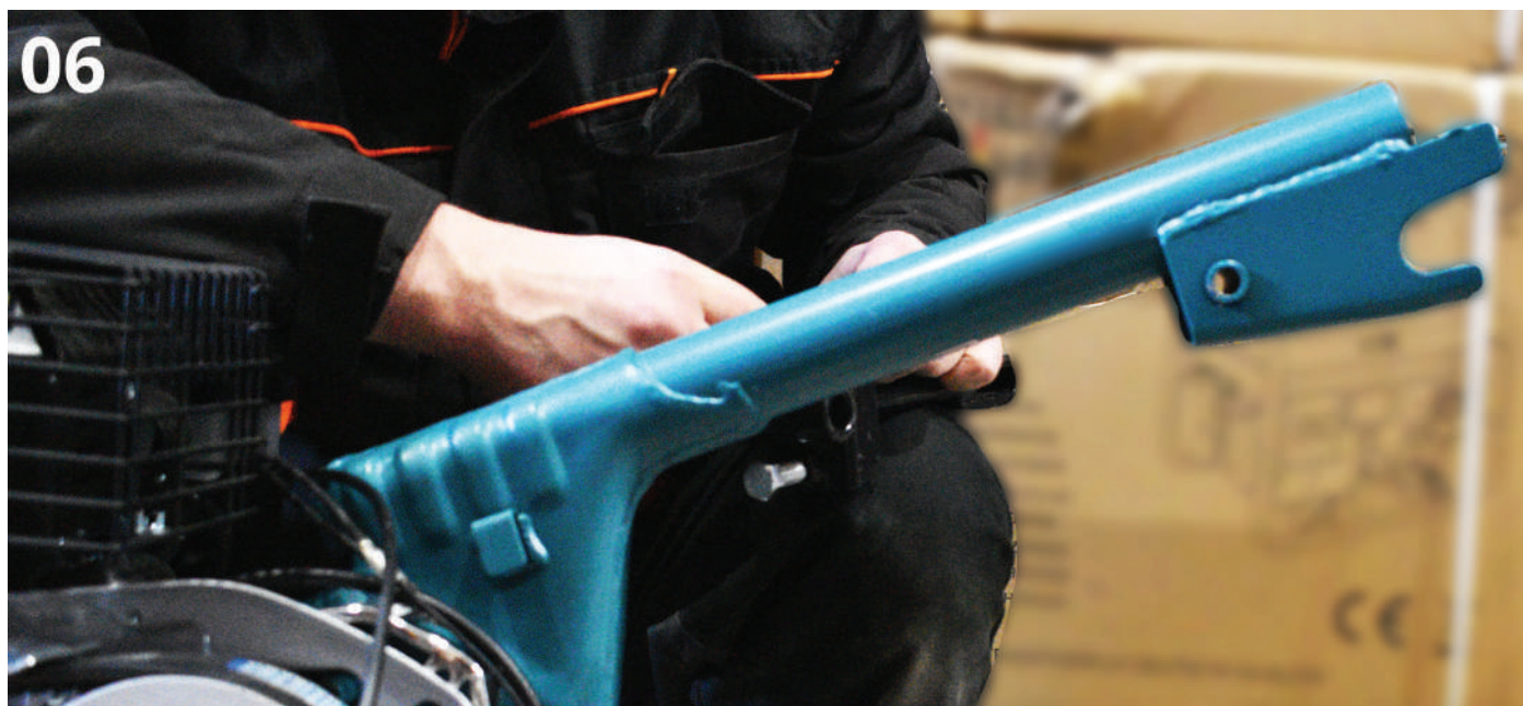
Abb. 7. Verriegeln Sie die Position des Steuergriffs mit der Klemmvorrichtung.
