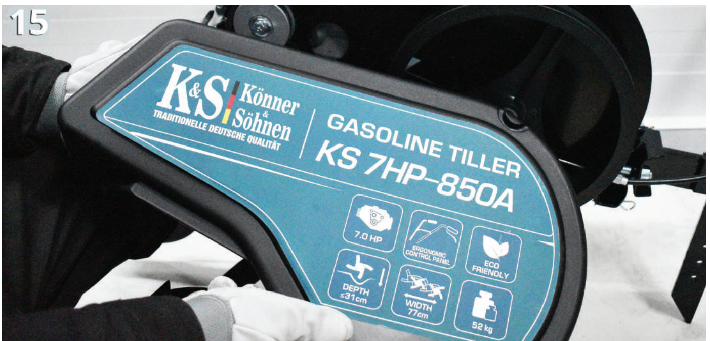
Abb. 15. Installieren Sie die Schutzabdeckung am Körper des Bodenhackens.
