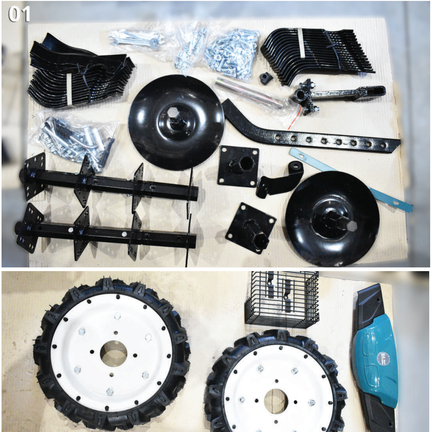
Abb. 1. Gesamtansicht des Benzin-Bodenhackens KS 7HP-1050G während der Vorbereitung zur Montage.
