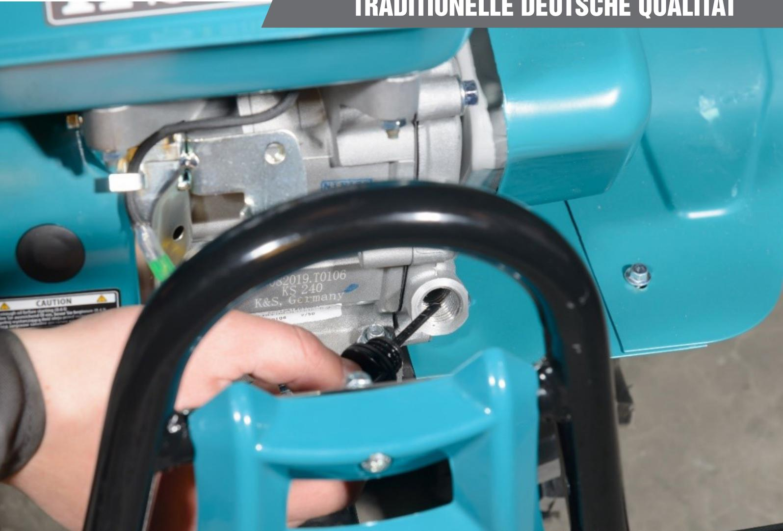
2. Füllen Sie in das Kurbelgehäuse das passende Motoröl ein.
