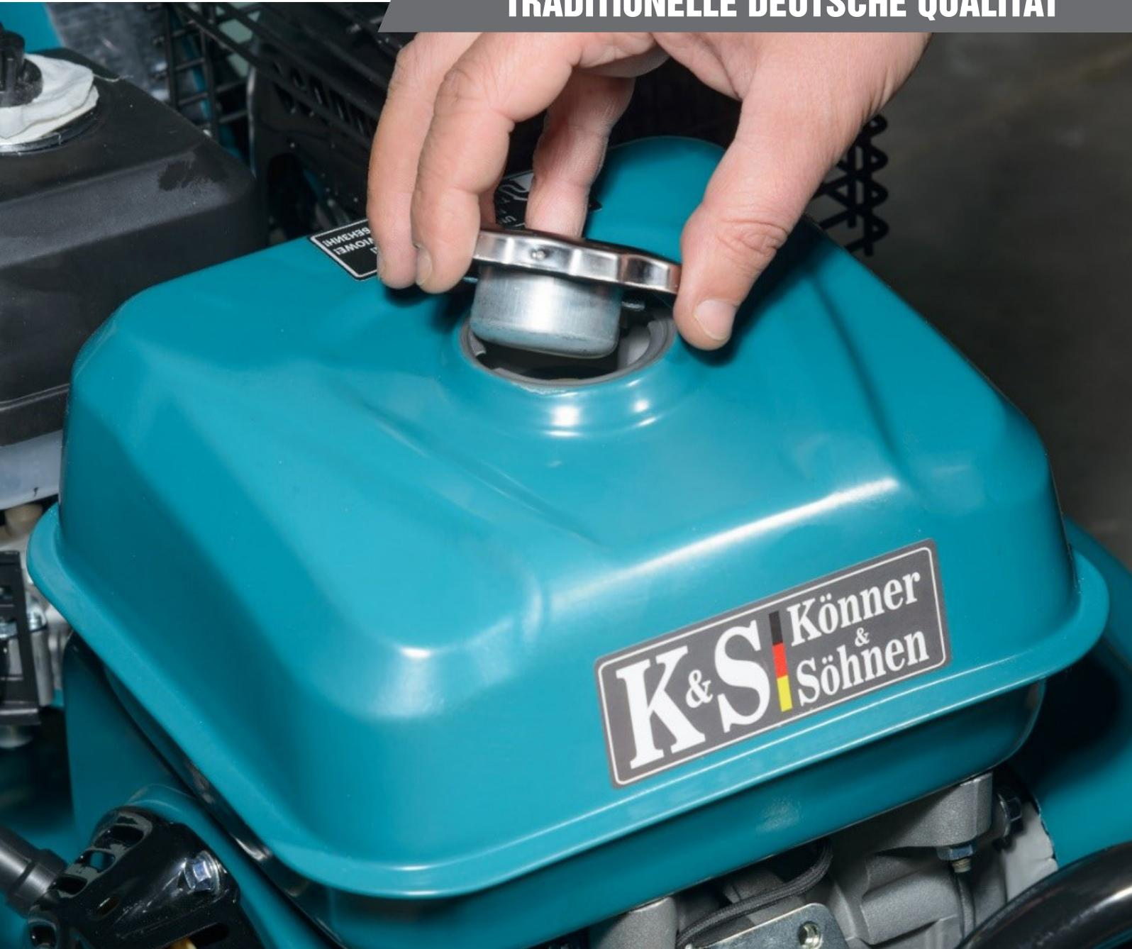
3. Benzin in den Kraftstoffbehälter einfüllen.
