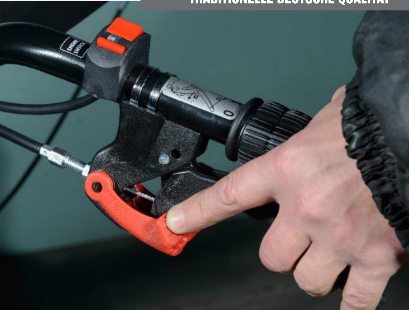
2. Drücken Sie die rote Sicherung (in der Nähe des Kupplungshebels) und halten Sie den Kupplungshebel gedrückt.
