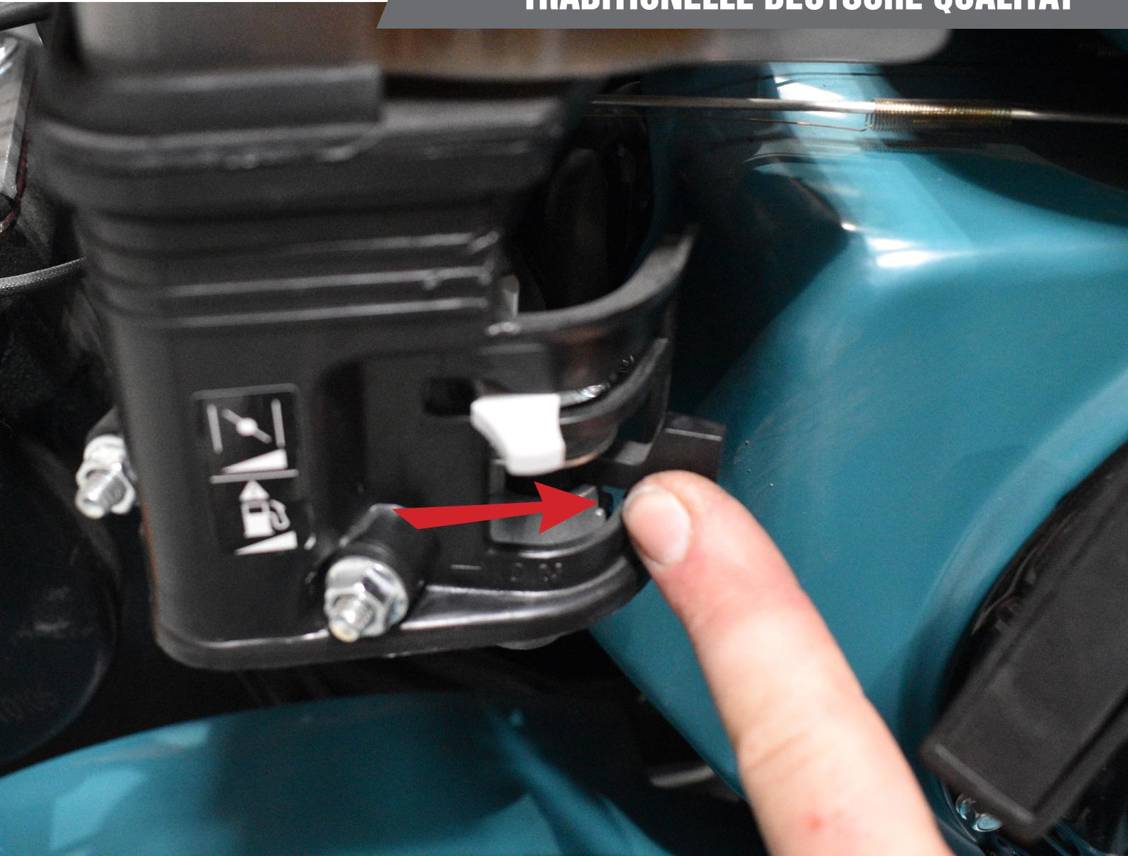
5. Stellen Sie den Hebel des Kraftstoffventils in die Position „Geöffnet“.
