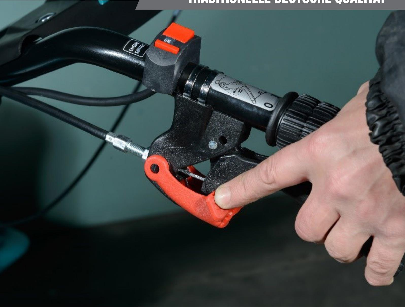
2. Drücken Sie vorsichtig die rote Sicherung (in der Nähe des Kupplungshebels) und halten Sie den Kupplungshebel gedrückt.
