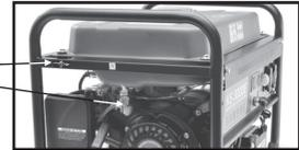
1. Posición de la válvula de mariposa para el arranque con gasolina
