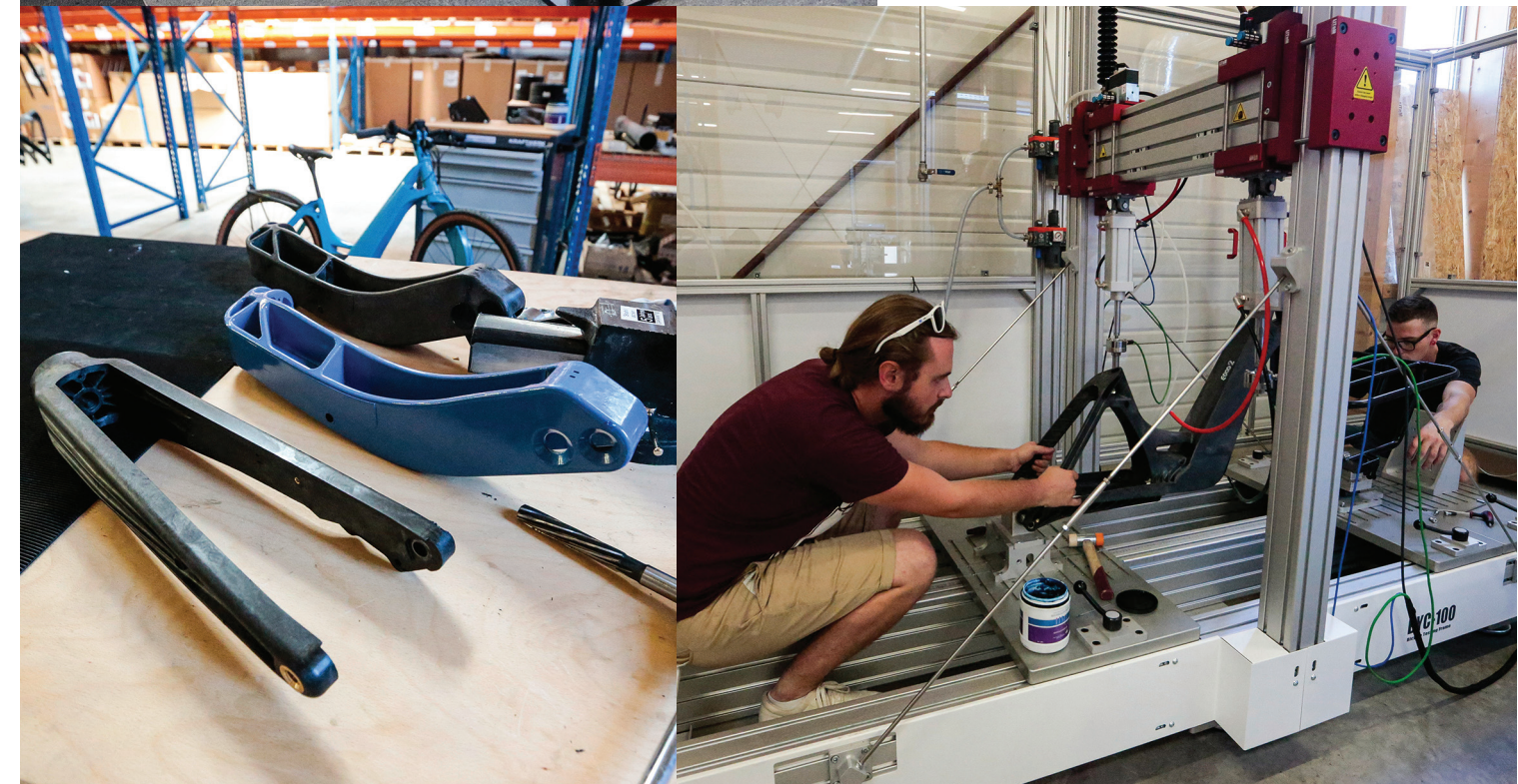
La mise en production du Multipath débute à peine dans la micro-factory de Saint-Priest, en banlieue lyonnaise. Les tests de fatigue des éléments du cadre sont réalisés en interne, sur un banc normalisé.
