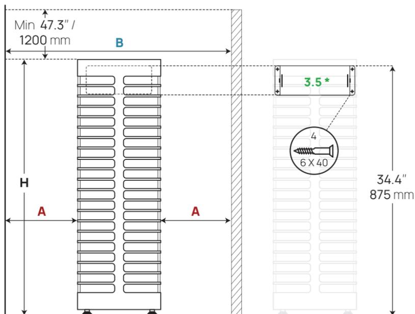
\* On fixe le poêle STEEL Mini 3,5 au mur à l'aide d'un support spécial
