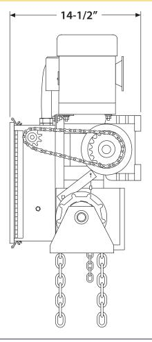
HEAVY DUTY #50 ROLLER CHAIN AND DRIVE SPROCKET INCLUDED
