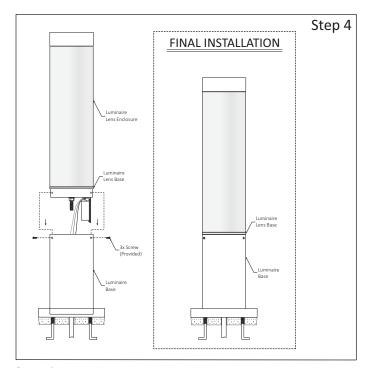
**Step 4** - Install Luminaire Lens Base:
